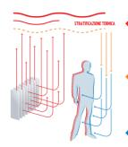
Cos'è la convezione: Il riscaldamento di tipo convettivo scalda prevalentemente l'aria ambiente che stratifica sul soffitto e comunque poi deve essere ovviamente cambiata con l'esterno causando una perdita di energia
